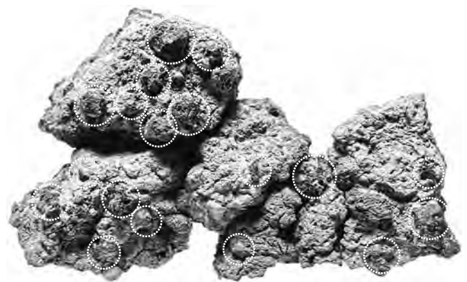
Fig. 91 Paroi de bas foyer (CHE 002/16970 CO, remontage de six fragments). Provenance: zone d'activité de forge, bas foyer 2/aire de forge 1. Face extérieure, l. 13,5 cm, h. 8,5 cm, poids 180 g. Présence répétée de fragments de scorie concassée, employés en tant que dégraissant (cercles); face extérieure.
