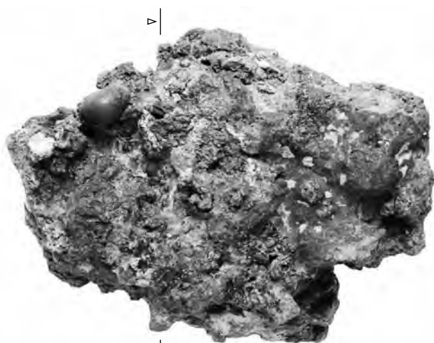
a. Scorie finement cristallisée avec structure de wustite sur des lattes de fayalite dans la matrice vitreuse.
