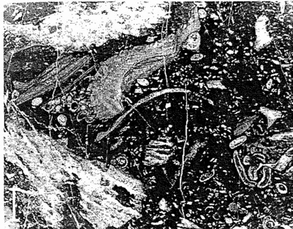
Fig. 26: Biomikrit mit Korallenfragmenten und Austernschalen mit aufgewachsenen Serpuliden. Schesaplana-Member, Murtèr (Terza-Einheit). Dünnschliff N-I 136. Balkenlänge = 2 mm.
