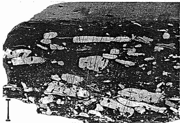
Fig. 40: Gerundete und angebohrte Lithoklasten aus Dolomit (hell) in Kalk (dunkel). Mitgel-Member, Fil da Stidier (Ela Decke). Angeätzter Anschliff. T-I 186. Balkenlänge = 1 cm.
