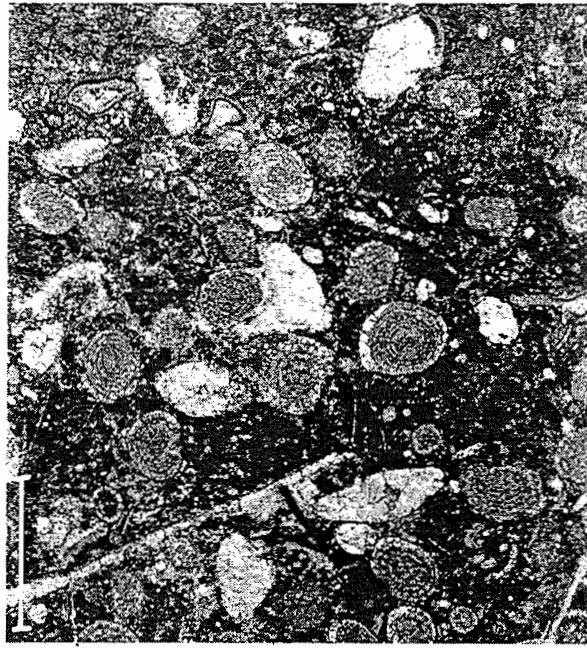
Fig. 36: Biomikrit mit unvollständig dolomitisierten Foraminiferen (u.a. *Triasina hantkeni* MAJZON). Schesaplana-Member, Murtèr (Terza-Einheit). Dünnschliff N-I 151; gefärbt: dunkel = Calcit, hell = Dolomit. Balkenlänge = 2 mm.
