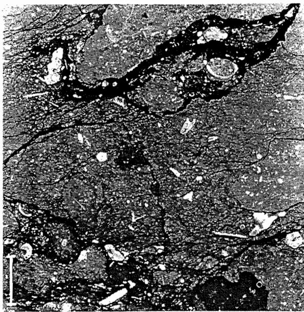
Fig. 59: Crinoiden-Biomikrit mit Tonflasern (Knollenkalk). Adnet-Kalk, Steinbruch Lorüns (Lechtal-Decke). Dünnschliff V-I 178. Balkenlänge = 2 mm.
