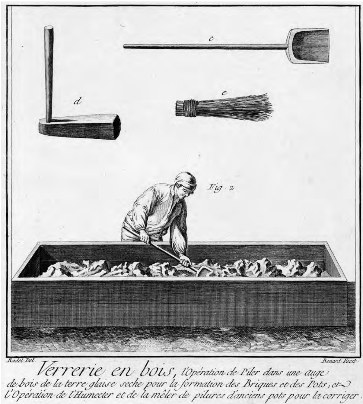
Fig. 128. Préparation des argiles à creusets. Diderot et D'Alembert, Encyclopédie: Verrerie en bois, pl. VI, extrait.
