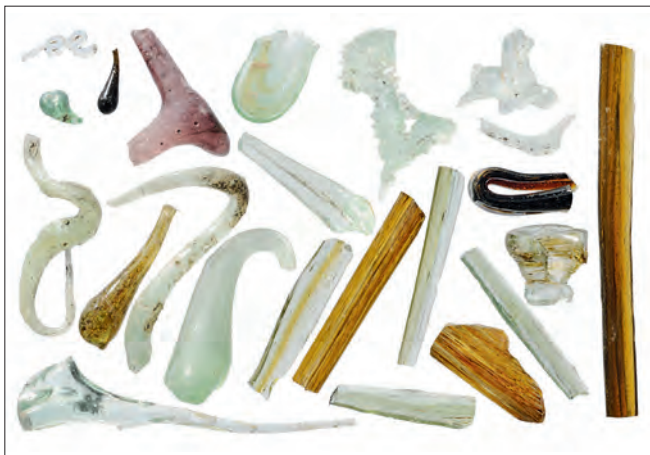
Fig. 140. Exemples de tests de matières de formes diverses (gouttes, rubans, fils ou vermicelles) récupérés comme groisil.
