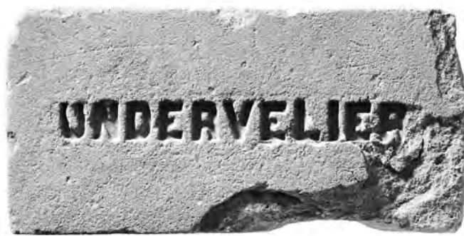
Fig. 159. Joue de carron portant l'inscription UNDERVELIER imprimée en creux. Dimensions de la brique : longueur : 23,5 cm, largeur : 11,5 cm, épaisseur : 3,7 cm
