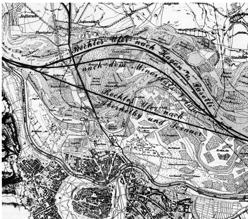
Abb. 3: Varianten der Donau-Regulierungs-Kommission, nach Hagen und Pasetti (oben) und Abernethy und Sexauer (unten, ausgeführt) (Michelmayr 1994)
