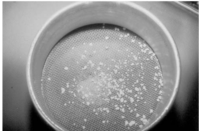
Abb. 3 Siebe mit absteigender Maschengröße zur Messung der Kaueffizienz
