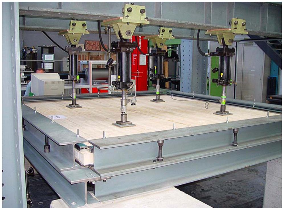
Der Abb. 4 kann beispielhaft die Messeinrichtung für Laststellung C entnommen werden. Während der ersten Belastungsphase wurden neben den Durchbiegungen auch
