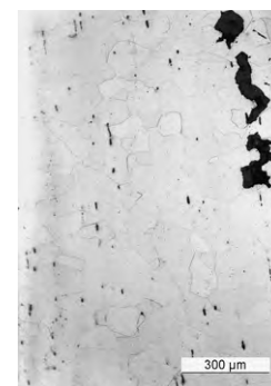
d. Grains de ferrite avec inclusions (attaque au Nital).
