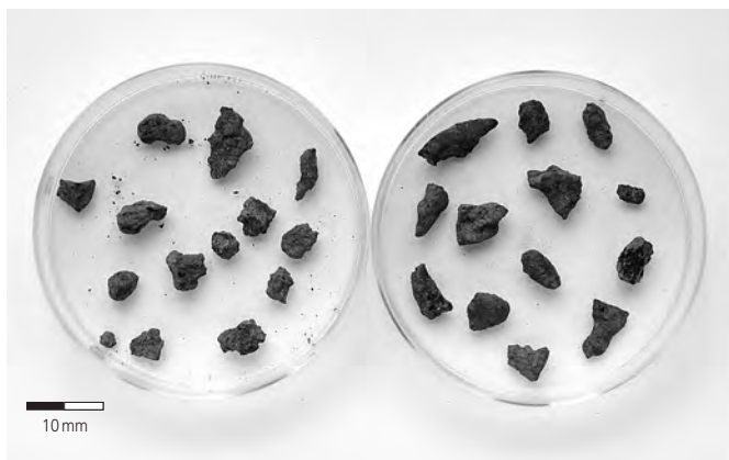
Fig. 85 Battitures. A gauche, battitures rouillées; à droite, battitures scoriacées.
