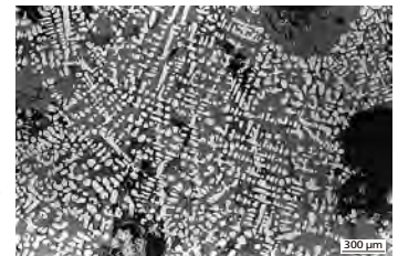
b. Dendrites de wustite (blanc) sur la fayalite équi-granulaire dans la matrice vitreuse.
