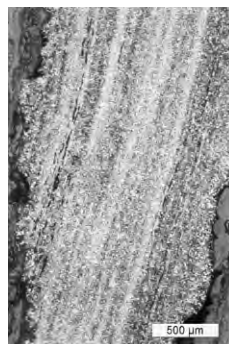
c. Trois couches en acier hypoeutectoïde, séparées par des inclusions de scorie (attaque au Nital).
