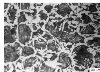
d. Perlite et ferrite aciculaire dans la couche centrale (attaque au Nital).
