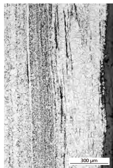
c. Trois couches en acier hypoeutectoïde avec structure de perlite (sombre) et ferrite (claire; attaque au Nital).
