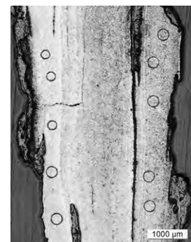
d. Fer (clair) et acier hypoeutectoïde (sombre; attaque au Nital).
