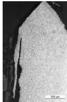
c. Pointe découpée en fer, surface légèrement cémentée (à gauche de l'image; attaque au Nital).
