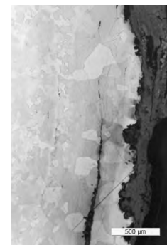
d. Structure de ferrite avec grains de petite et de grande taille (attaque au Nital).
