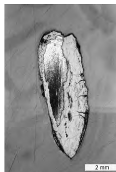
c. Vue générale. Les parties sombres sont plus riches en carbone que les parties claires (attaque au Nital).
