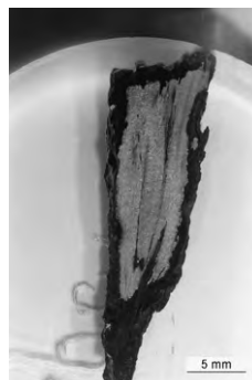
c. Vue générale. Des ségrégations sombres marquent les soudures (attaque au réactif d'Oberhoffer).
