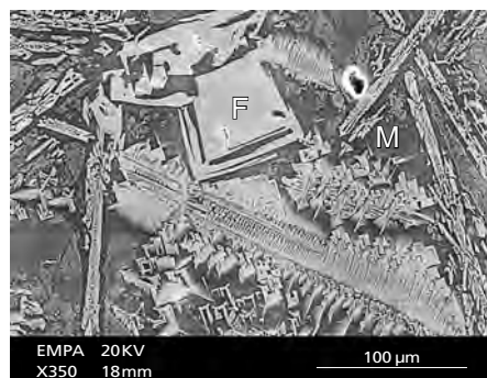
Fig. 12 Fayalite (F) de forme squelettique, équi-granulaire et en latte, dans la matrice vitreuse (M) (calotte avec vitrification cat. 15, images MEB, mode SE).
