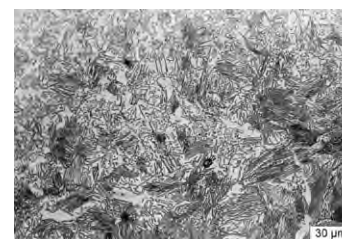
d. Le métal dans la pointe est un acier presque eutectoïde. La structure de perlite lamellaire et globulaire est due à un recuit (attaque au Nital).
