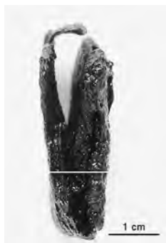
a. Matière de récupération repliée avec localisation de prise d'échantillon.
