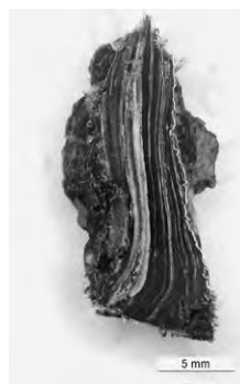
c. Vue générale. Les ségrégations rendent visibles plusieurs couches (attaque au réactif d'Obendorffer).
