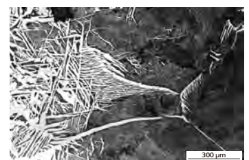
d. Acier eutectoïde à bord décarburé : perlite lamellaire et ferrite aciculaire.
