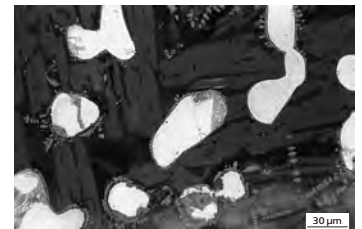
d. Inclusions d’acier à structure de ferrite et de perlite lamellaire dans la scorie. Le bord du métal, couronné d’oxydes de fer, témoigne d’un milieu oxydant.
