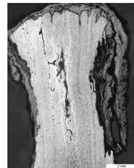
d. Couches soudées d'acier hypoeutectoïde dans la tête du ciseau (attaque au Nital).
