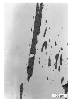
d. Inclusions de scorie avec structure de wustite vermiculaire dans une matrice amorphe (attaque au Nital).
