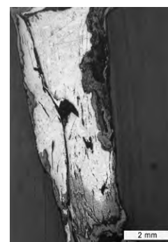
d. La tige est elle aussi en fer, avec cémentation vers la pointe (attaque au Nital).
