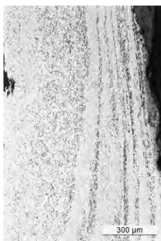
c. Bord en acier hypoeutectoïde avec ségrégations en ligne dues au martelage à chaud (attaque au Nital).
