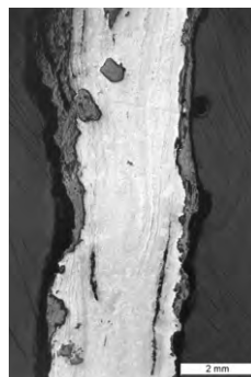
c. Fer (blanc) et produit de corrosion (gris; attaque au Nital).
