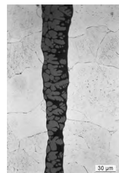
d. Ferrite impure et inclusion de scorie avec structure de wustite dendritique (attaque au Nital).
