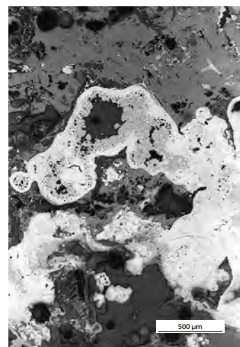
a. Couche de métal corrodé (blanc) dans de la scorie fayalitique.
