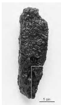
a. Ciseau à pointe avec localisation de la prise d'échantillon.
