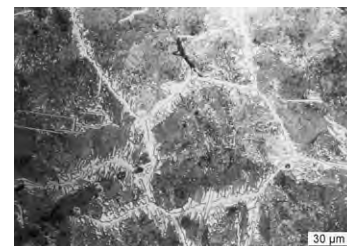
d. Acier hypoeutectoïde avec structure de perlite lamellaire et ferrite aciculaire (attaque au Nital).
