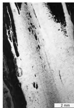
c. Vue générale. Fer et acier hypoeutectoïde au centre (attaque au Nital).
