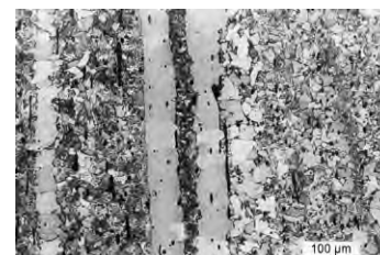
d. Des bandes de ségrégations ferritiques marquent les soudures entre différentes couches en acier hypoeutectoïde (attaque au Nital).
