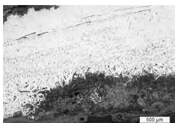
c. La section montre du fer et de l'acier hypoeutectoïde fortement cémenté vers le bas de l'image (attaque au Nital).
