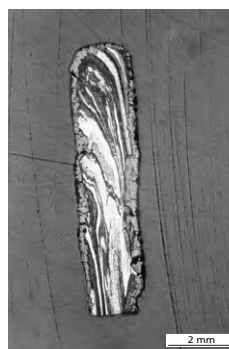
c. Section (attaque au réactif d'Oberhoffer): les parties riches en phosphore (blanc) marquent partiellement les soudures.
