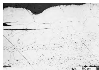
d. Ferrite à gros grains et ferrite avec cémentite aux joints des grains (attaque au Nital).
