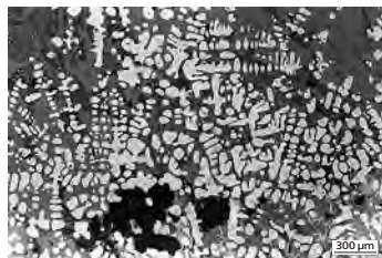
a. Couche inférieure gris sombre. La scorie présente une structure de dendrites de wustite sur des olivines et de leucite symplectique avec la wustite.
