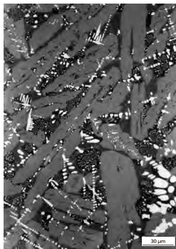
c. Scorie riche en olivine à structure de dendrites de wustite sur des olivines allongées, et leucite symplectique avec la wustite dans la matrice vitreuse.
