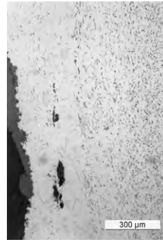
c. L'objet consiste en acier hypoeutectoïde avec bord décarburé (attaque au Nital).
