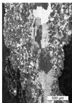
c. La grandeur de grains varie suivant la teneur en carbone: les grains grossiers sont en fer, les petits en acier hypoeuctoïde (attaque au Nital). Lumière polarisée.
