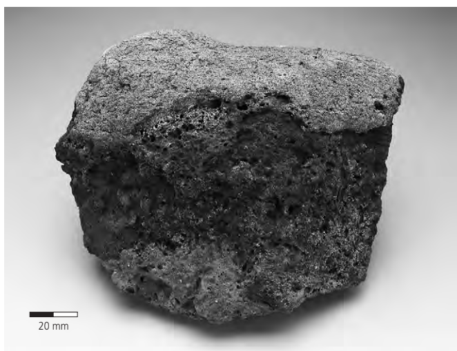
Fig. 36 Face inférieure d'un fragment de calotte, avec traces du placage sableux provenant des parois du bas foyer.
