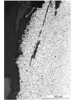
d. Surface cémentée avec structure de ferrite (blanc) et perlite (noir; attaque au Nital).
