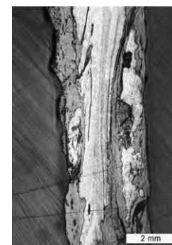
d. Ferrite recristallisée et grains fins le long de la soudure (attaque au Nital).
