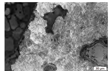
d. Surface décarburée à structure de perlite, enrobée de scorie (wustite dans la matrice vitreuse).
