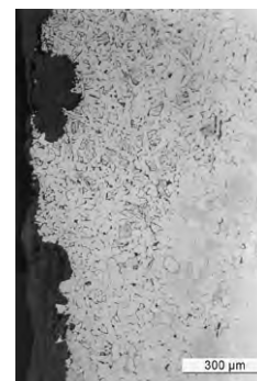
d. Perlite et ferrite au bord, ferrite au centre (attaque au Nital).
