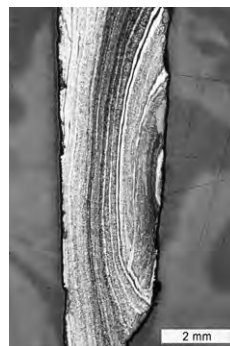
c. Vue générale. Les couches sombres contiennent plus de charbon que les couches claires (attaque au Nital).
