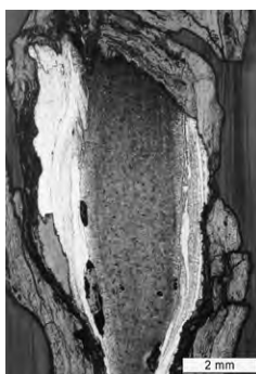
c. Centre en acier eutectoïde (sombre), surfaces en acier hypoeutectoïde (clair; attaque au Nital).
