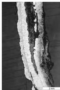
c. Section montrant une ligne de soudure (attaque au Nital). Fer (clair), acier hypoeutectoïde (sombre) et parties corrodées (gris).
