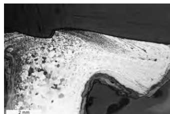
c. Vue générale. La tête consiste en deux parties soudées entre elles. Les zones sombres en haut de l'image sont plus riches en carbone (attaque au Nital).
