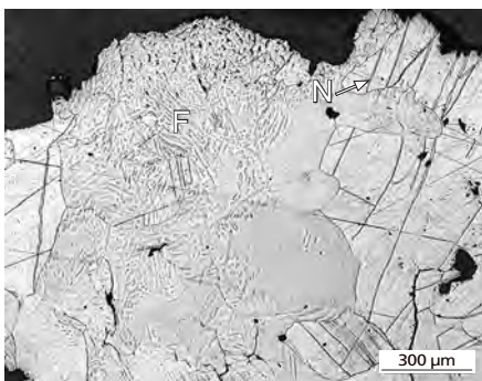
Fig. 28 Fer riche en phosphore à structure de ferrite, contenant des bandes de Neumann (N) et des structures fantômes (F) (déchet de raffinage cat. 67; micrographie).
