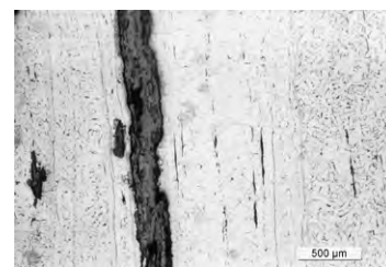
d. Couches en fer et en acier hypoeutectoïde soudées entre elles (attaque au Nital).
