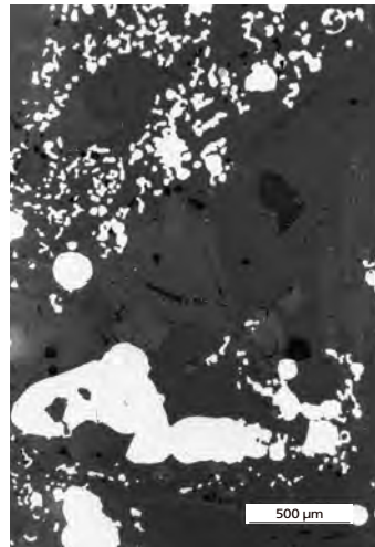
b. Scorie à structure de spinelles sur des olivines dans la matrice vitreuse. En blanc, le métal en cours de formation.
