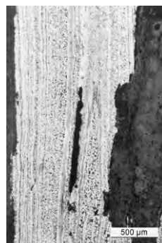
c. Vue générale. L'acier hypoeutectoïde contient des soudures marquées par des ségrégations en bande (attaque au Nital).
