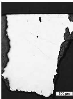
c. Section (non attaqué): métal avec inclusions de scorie et produits de corrosion (gris).
