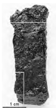
a. Chute avec localisation de prise d'échantillon.
