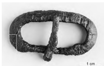
a. Boucle (de ceinture) avec localisation de la prise d'échantillon.
