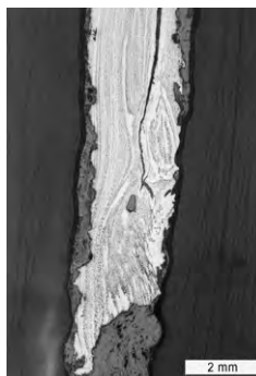
c. Vue générale. Des ségrégations divisent le fer (blanc) et l'acier hypoeutectoïde (gris) (attaque au Nital).
