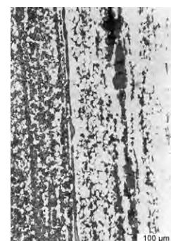
d. Ferrite et perlite en concentrations variable selon les couches (attaque au Nital).
