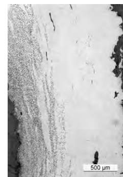
d. Bord cémenté en acier hypoeutectoïde et fer avec inclusions de scorie (attaque au Nital).
