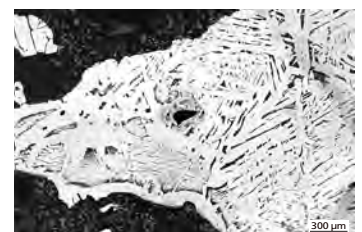
d. Inclusion d'acier hypoeutectoïde dans la scorie. L'acier présente une structure de Widmannstätten.
