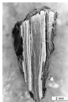
c. Le réactif d'Oberhoffer rend visible les ségrégations le long des soudures qui forment cinq couches.
