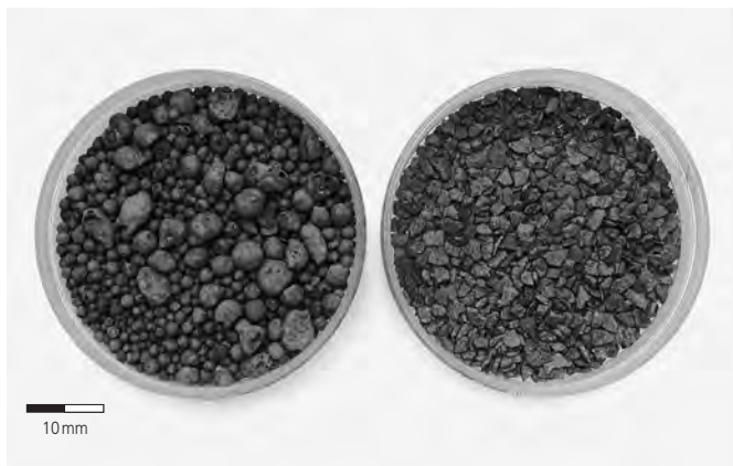
Fig. 84 Battitures. A gauche, battitures globulaires; à droite, battitures lamellaires.
