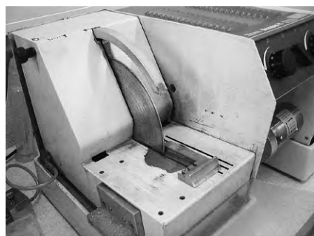
Fig. 255 Tronçonneuse à disque diamanté refroidie à l'eau.
