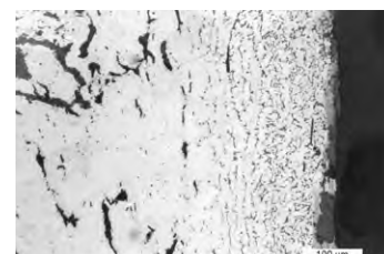
d. Bord cémenté en acier hypoeutectoïde et fer avec inclusions de scorie (attaque au Nital).
