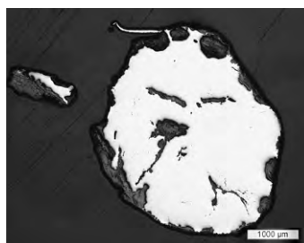
c. Section (non attaqué): métal (blanc) et gris produits de corrosion (gris).
