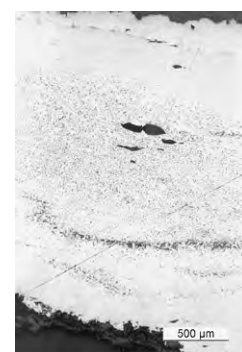
c. Répartition du carbone: ferrite en surface, acier hypoeutectoïde au centre (attaque au Nital).
