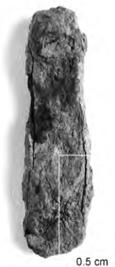
a. Fragment d'outil (lame) avec localisation de la prise d'échantillon.
