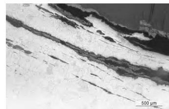
c. Fer séparé par des produits de corrosion et des inclusions de scorie le long des soudures (attaque au Nital).
