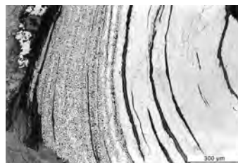
c. Couches soudées d'acier hypoeutectoïde (sombre) et de ferrite à gros grains (clair) (attaque au Nital).
