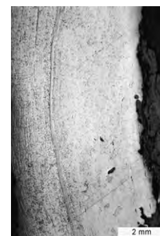
c. Vue générale avec soudure: fer et acier hypoeutectoïde (attaque au Nital).
