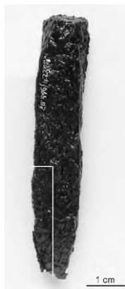
a. Ciseau à pointe avec localisation de la prise d'échantillon.
