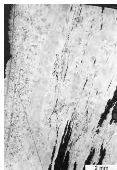
c. Vue générale. Le métal montre une structure de ferrite (attaque au Nital).
