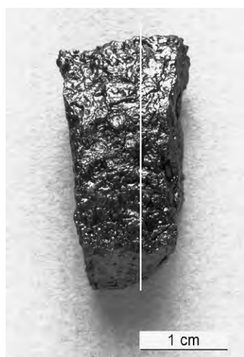
a. Fragment d'outil (tranchant) avec localisation de la prise d'échantillon.
