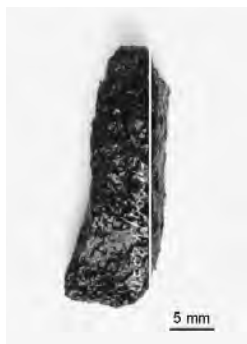
a. Fragment d'outil (lame) avec localisation de la prise d'échantillon.
