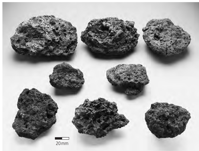
Fig. 37 Scories en forme de calotte. De gauche à droite, et de haut en bas : calotte avec bourrelet (BO) inv. CTT 994/54478 TI calotte concave (CO) inv. CTT 994/54385 TI calotte convexe (CX) inv. CTT 994/55124 TI calotte dense petite (DP) inv. DEV 994/55496 PR calotte avec vitrification (VI) inv. CTT 994/57253 TI calotte aplatie (AP) inv. DEV 994/50855 PR calotte avec empreintes de charbon (CH) inv. CTT 995/50008 TI calotte avec quille (QU) inv. CTT 994/56204 TI.
