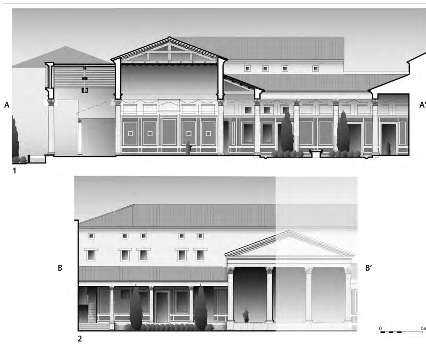
Fig. 5. Hypothèse de restitution des élévations. 1. Coupe axiale A-A' de l'avant-corps du grand oecus et du péristyle; 2. Coupe B-B' façade sur jardin du portique latéral et avant-corps à fastigium. (C. Gaston - INRAP)
