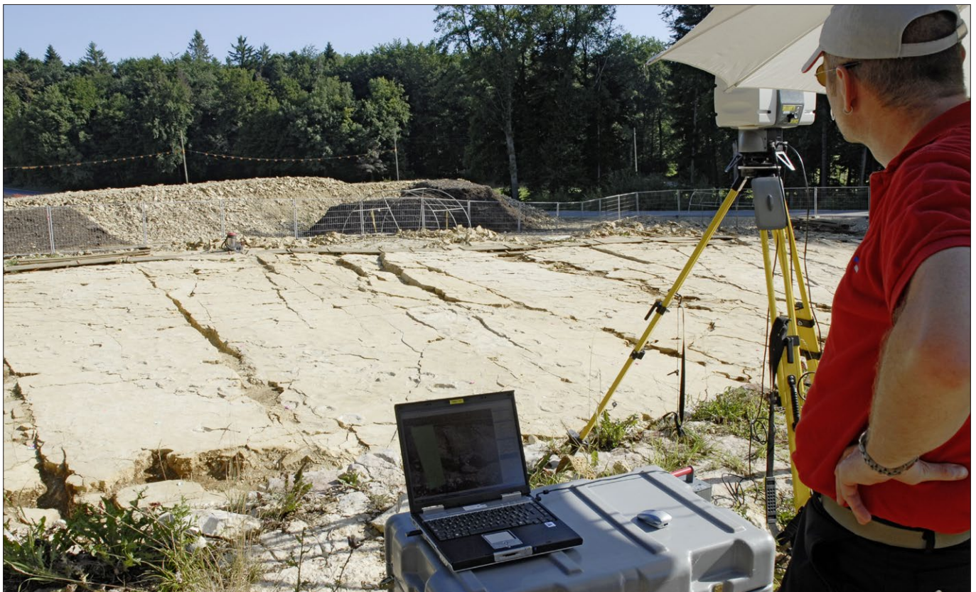
Fig. 170. Réalisation d'un balayage laser sur la couche 1000 du site de Courtedoux-Bois de Sylleux.
