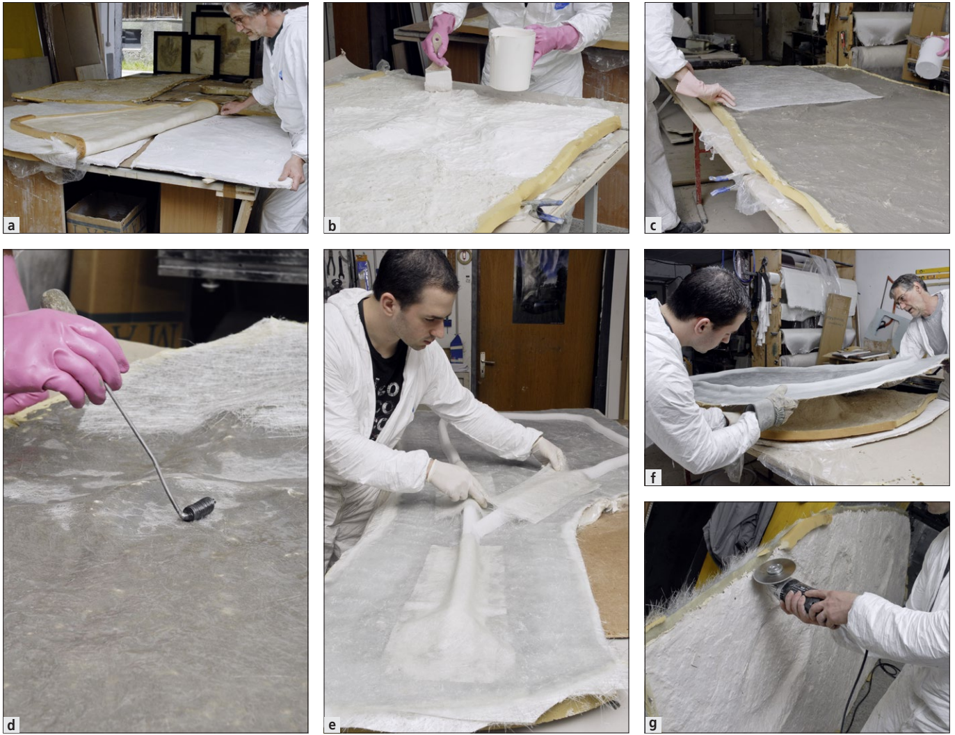
Fig. 112. a) silicone posé sur les coques en plâtre, prêt à être copié; b) imprégnation du silicone avec une couche de surface, le gelcoat; c) le mat de fibre de verre est posé sur la couche de résine; d) suppression des bulles d'air au moyen d'un rouleau débulleur; e) collage des renforts en polyéthylène; f) démoulage de la copie en polyester; g) découpe des bords au moyen d'une meule en diamant.
