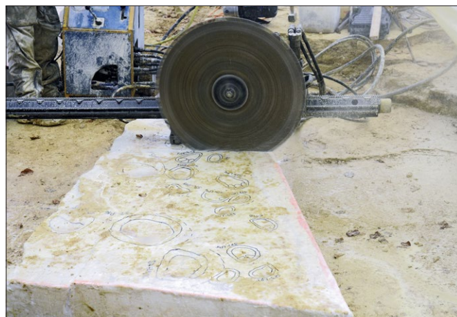
Fig. 130. Sciage vertical pour réduire la taille des blocs et faciliter leur transport.
