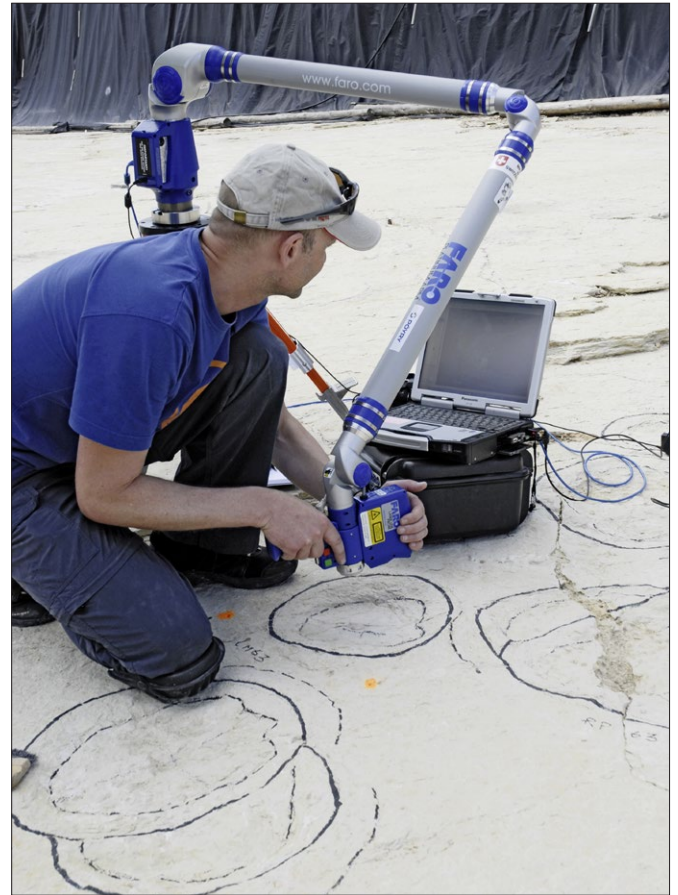
Fig. 172. Balayage laser haute définition réalisé à Courtedoux-Béchat Bovais.
