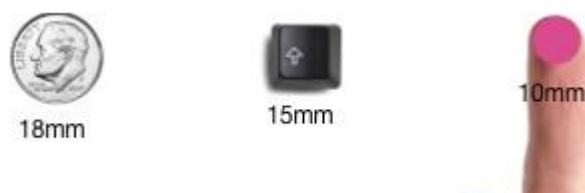
Figure 7 : Comparaison de la zone de pression d'un doigt avec une pièce équivalente à 0.50 CHF et une touche de clavier
