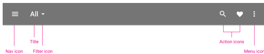
Figure 15 : Exemple de barre principale
