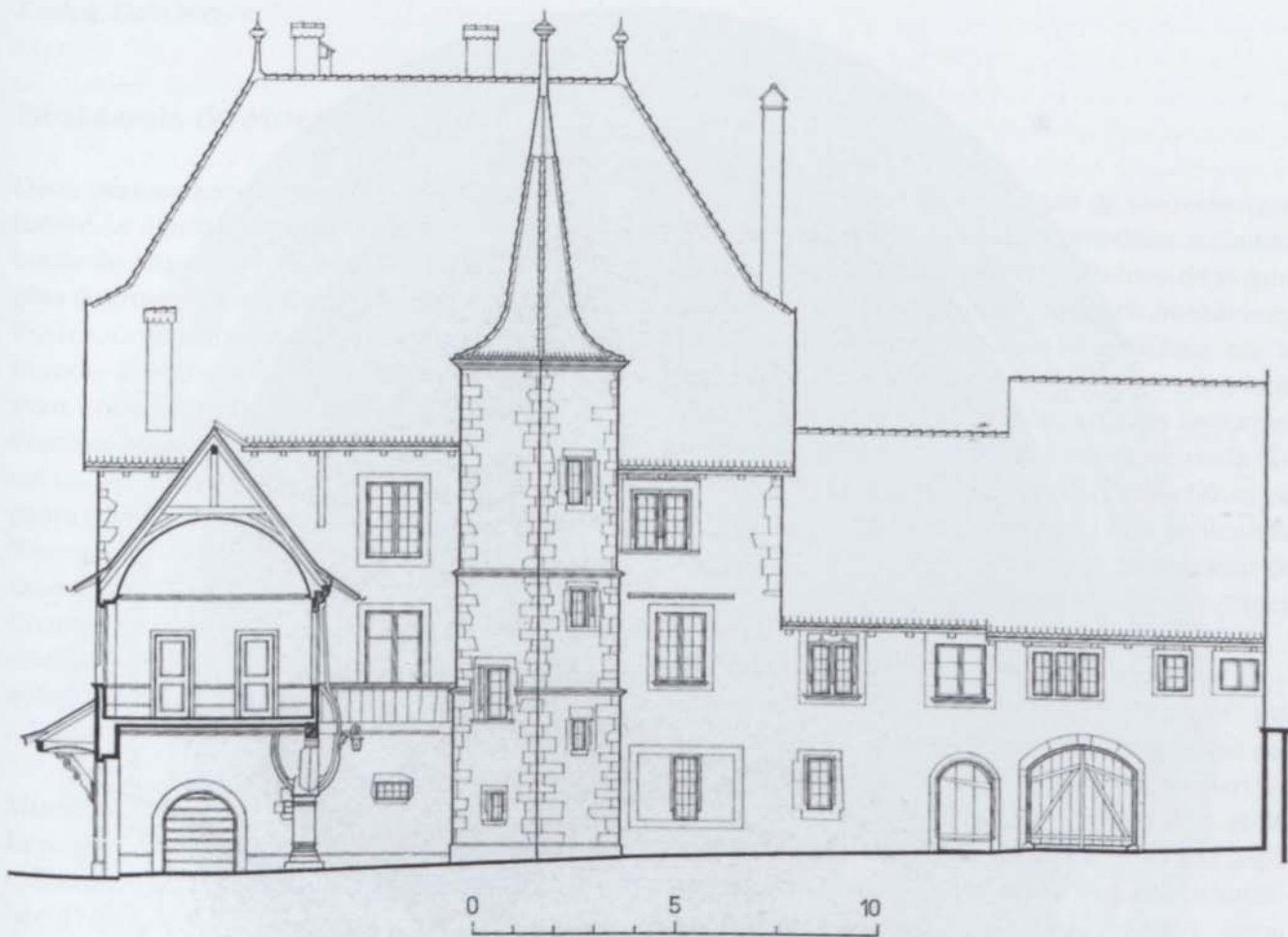
Relevé de la façade sur cour du Pontet, avec à gauche la coupe sur la galerie de 1626-1627.
