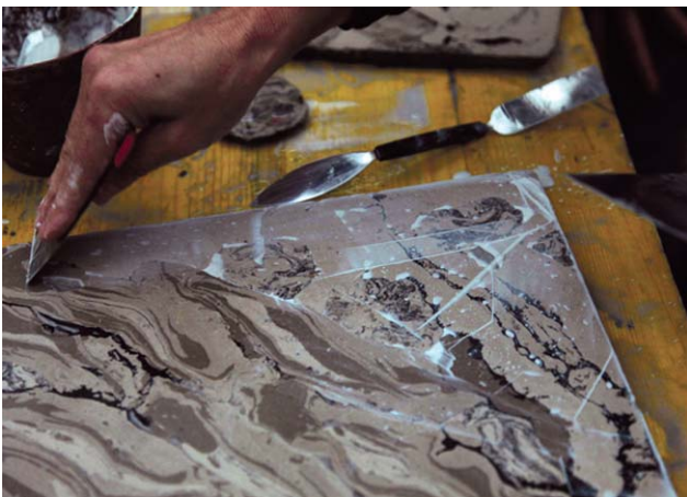
Abb. 5: Herstellung von Stuckmarmor (Foto: Katalin Deér)
