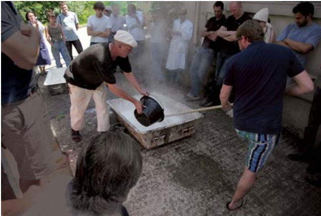
Abb. 4: Ablöschen von Kalk (Foto: Katalin Deér)
