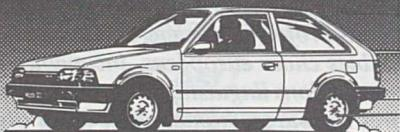
3 portes. Moteur à injection de 1,3 litre, 49 kW/67 ch. Boîte à 5 vitesses. Freins à disques ventilés à l'avant. Dossiers arrière rabattables séparément. Équipement très complet et finition soignée.
