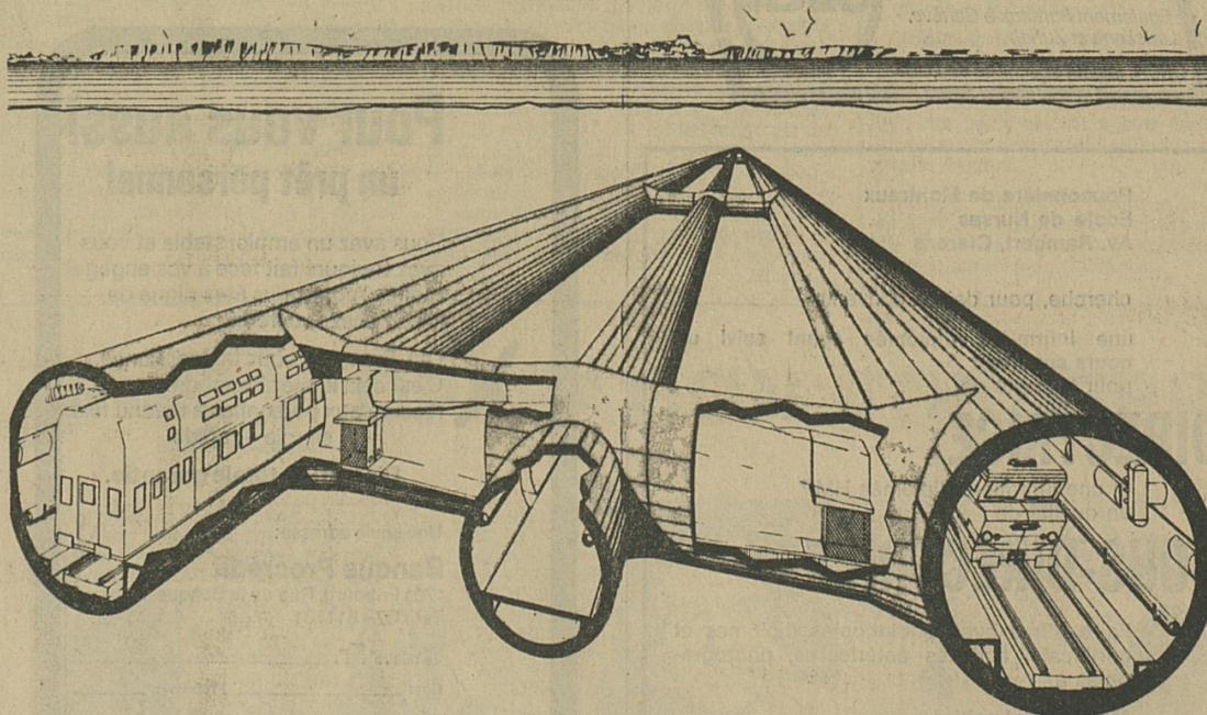
Une vue en perspective du tunnel projeté, avec ses deux galeries principales dans lesquelles circulent deux rames de trains, avec au milieu la galerie de service.
