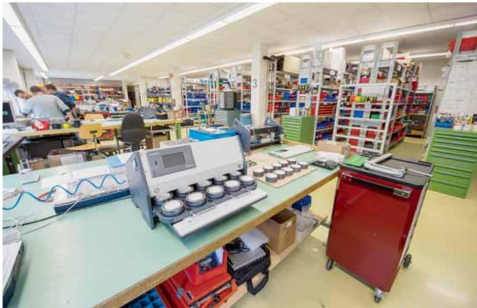
Dans les ateliers Roxer de la rue du Collège, la Decarox, une machine «révolutionnaire» dans laquelle les horlogers peuvent tester simultanément l'étanchéité de dix montres en un temps record. LUCAS VUJTEL
