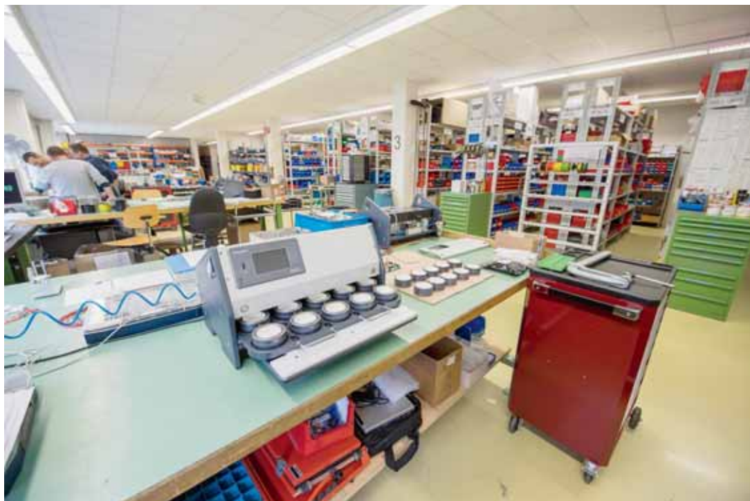
Dans les ateliers Roxer de la rue du Collège, la Decarox, une machine «révolutionnaire» dans laquelle les horlogers peuvent tester simultanément l'étanchéité de dix montres en un temps record. LUCAS VUITEL
