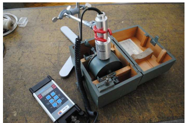
Fig. 45 : Prise de mesures avec le radiamètre. ©HECR Arc, 2012
