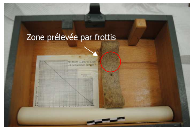
Fig. 49 : Couvercle de la boîte de l'anémomètre. Le soutien est en contact avec le cadran radioluminescent. ©HECR Arc, 2012
