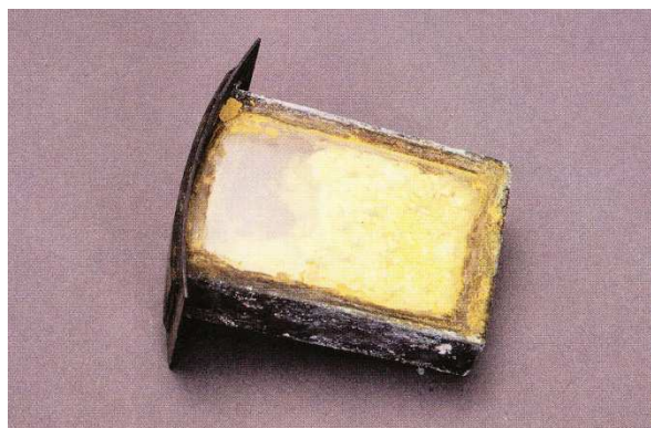
Fig. 3 : Sulfate double d'uranyle et de potassium ayant servi à la découverte de la radioactivité. ©St-Hilaire
