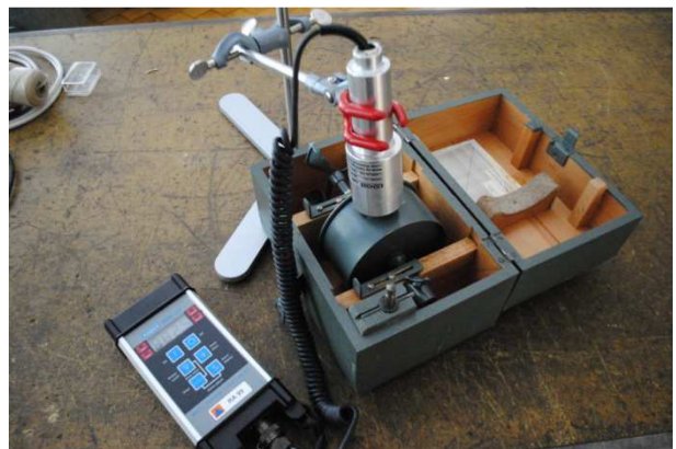
Fig. 55 : Utilisation d'un statif et d'une noix pour réaliser des mesures comparables ©HECR Arc, 2012
