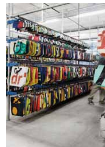
Des bâches de camions dépecées dans le hall de l'usine «Noerd» de Freitag, dans la zone industrielle de Zurich. Les bâches sont lavées à l'eau de pluie avant d'être transformées en sacs. SP FREITAG-ROLAND TÄNNLER
