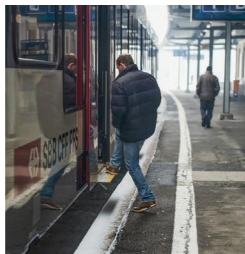
Au Locle – mais aussi à Neuchâtel au nord – le quai n'est pas à niveau. CHRISTIAN GALLEY
