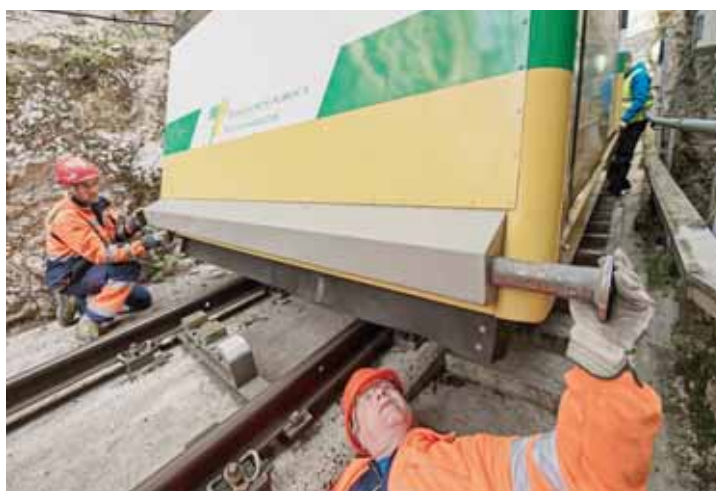
Les spécialistes fixent d'abord les tiges de métal sur lesquelles s'accrocheront les élingues de l'autogreue (à gauche). La voiture de 4,5 tonnes est ensuite soulevée doucement de sa voie.
