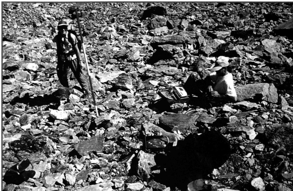
Photo 4 – Réalisation d'un sondage sur un glacier rocheux durant la campagne de l'été 1998. – PHOTO EMMANUEL REYNARD
