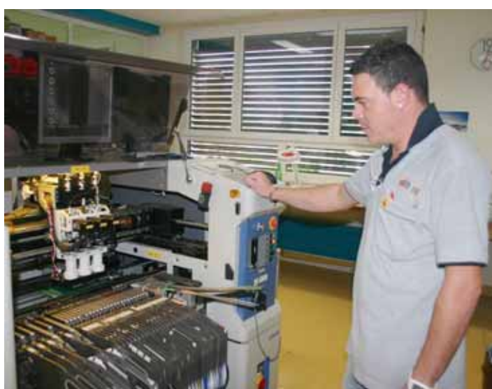
Placement automatique des composants.
