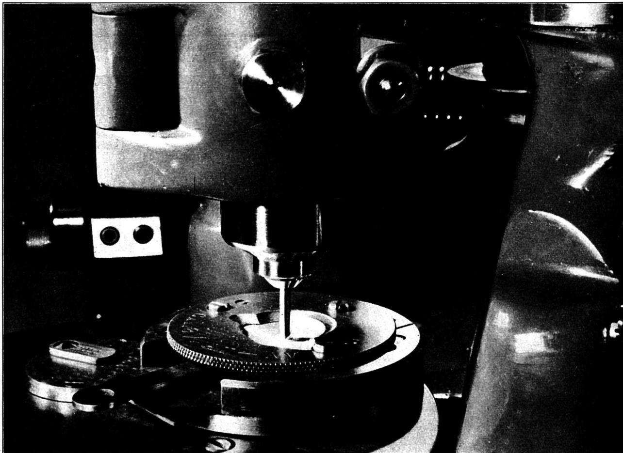
La machine universelle basée sur le principe des trois cames comme les automates Jaquet-Droz.
