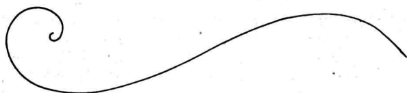
Fig. 3. - Ressort « Dura Power » (Elgin). Longueur 184 mm, hauteur 1,286 mm, épaisseur 0,076 mm.
