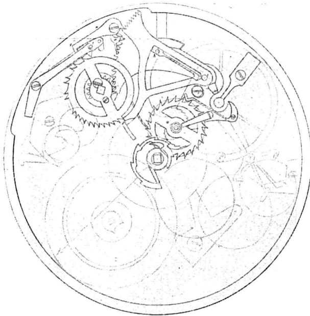
Fig. 4. — Cadrature dite de Stagden, reproduite plus ou moins exactement, suivant Moinet, par Breguet, sous le nom de « cadrature à trois vis ».
