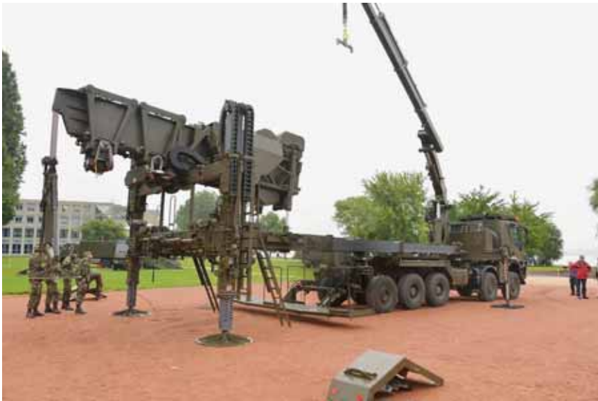
Cette infrastructure permet de créer un pont de 46 mètres en 90 minutes.
