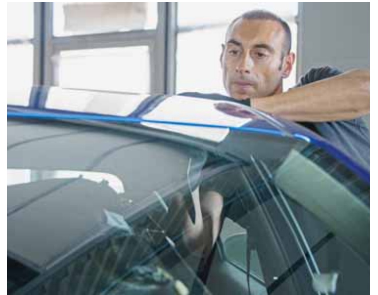
Les experts effectuent un véritable massage de la tôle endommagée.
