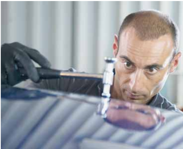
L'Italien Fabio Arosio égalise la tôle au moyen d'un petit marteau.
