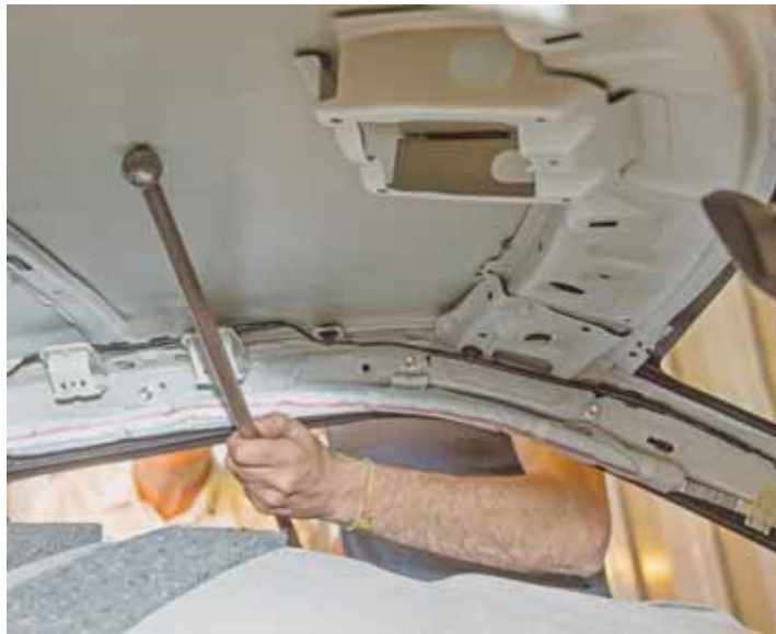
Les bosses sont redressées depuis l'intérieur du véhicule.
