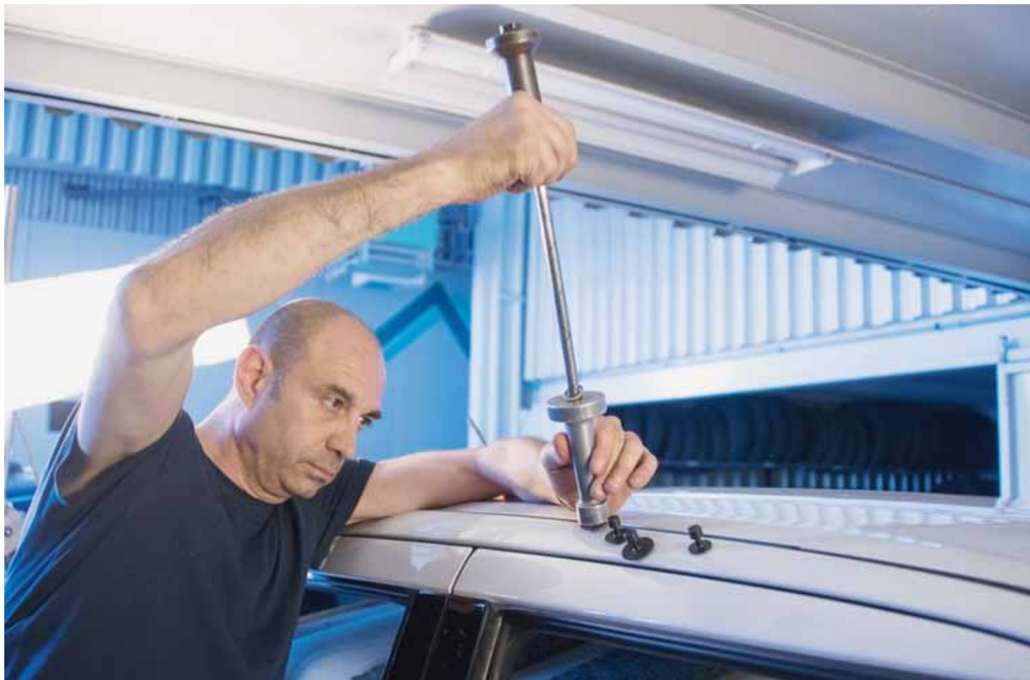
Michele Palmisano s'est spécialisé dans le débosselage des carrosseries. Il se déplace dans le monde entier, là où les orages de grêle sévissent. Avec de petites ventouses, il parvient à redresser certains trous.
