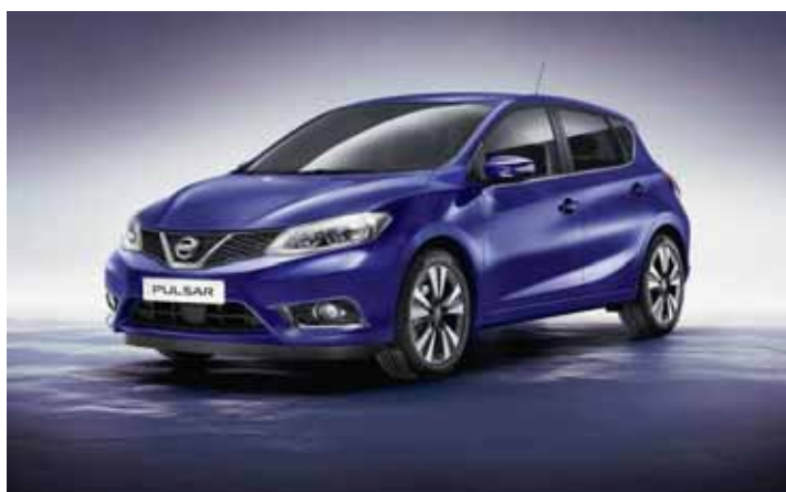
Adoptant le «bouclier de sécurité» des Note et Quashai, la Pulsar recevra des moteurs turbocompressés, essence de 115 et 190 ch, et diesel dCi de 110 ch notamment. Et la nouvelle bva Xtronic sera aussi de la partie. SP
