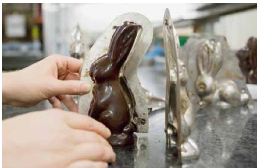
C'est l'effervescence à la confiserie Walder de Neuchâtel, où l'on fabrique les derniers lapins de Pâques. Le chocolat fondu est coulé dans le moule puis refroidi. Après le démoulage, les imperfections sont corrigées au couteau.
