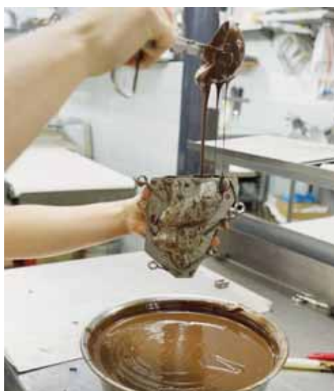
C'est l'effervescence à la confiserie Walder de Neuchâtel, où l'on fabrique les derniers lapins de Pâques. Le chocolat fondu est coulé dans le moule puis refroidi. Après le démoulage, les imperfections sont corrigées au couteau.
