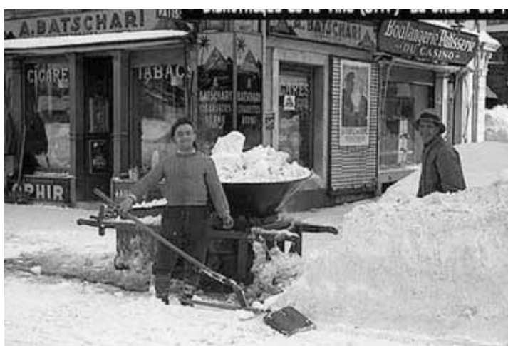
Une machine à fondre la neige immortalisée en 1938 par le photographe Fernand Perret. BIBLIOTHÈQUE DE LA VILLE
