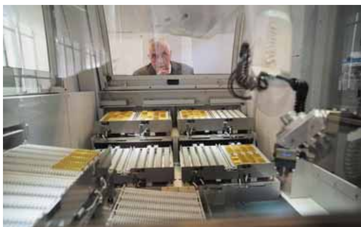
Des machines ultramodernes, de marque Précitrame, permettent d'usiner les platines qui recevront les composants du mouvement.
