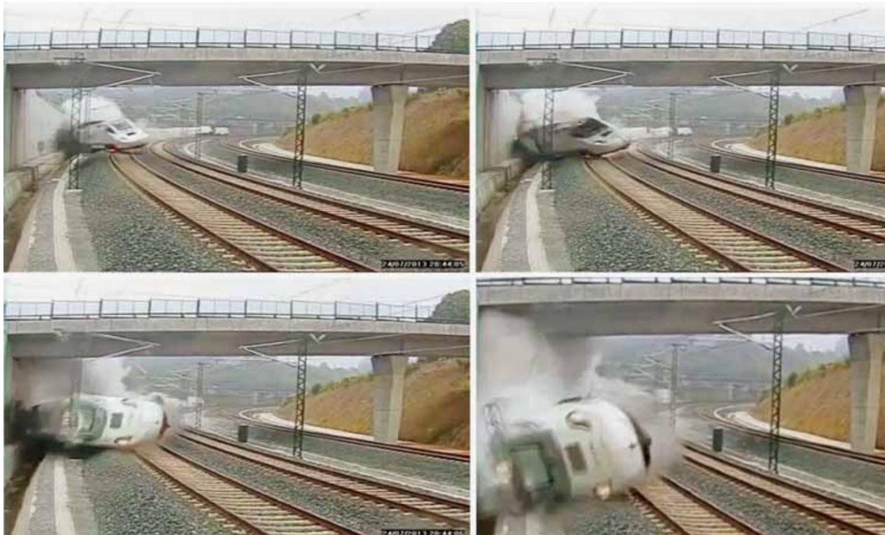
Le train à grande vitesse doit passer en seulement quelques secondes de 200 km/h à 80 km/h afin de prendre ce virage en toute sécurité. Selon «El País», le train circulait à 190 km/h à ce moment précis. KEYSTONE
