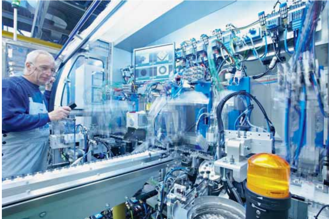
Les lignes de Mikron peuvent assembler jusqu'à 600 produits à la minute. SP
