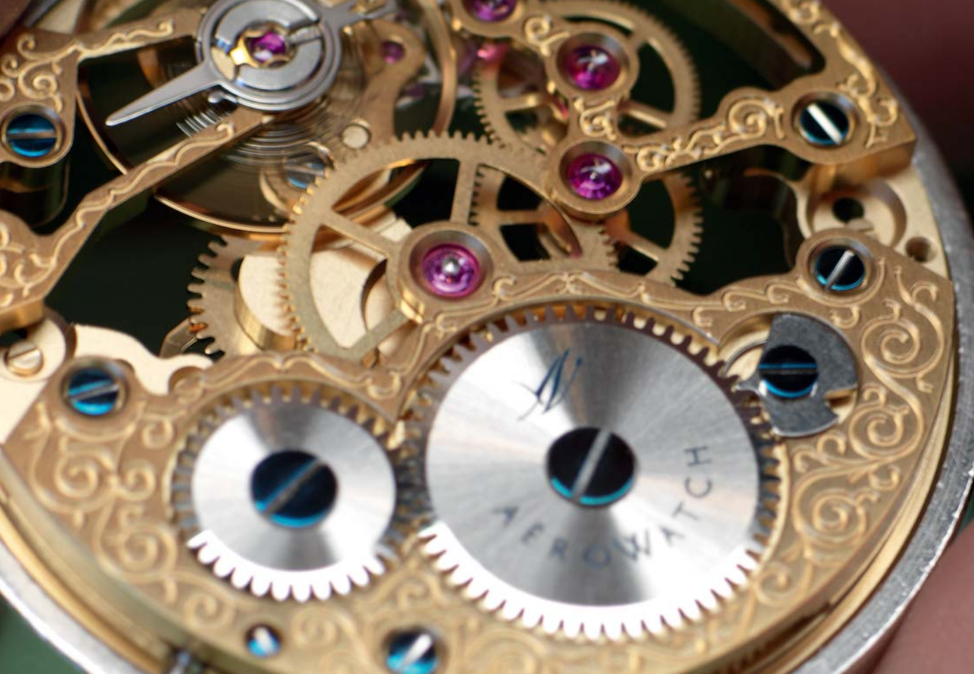
Mouvement squelette d'une montre de poche
