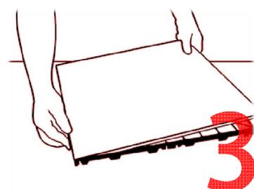
Enfiler un angle du carreau dans un des angles du support. Suivant les angles du gabarit du support, faire pression jusqu'à ce que le carreau adhère au support.
