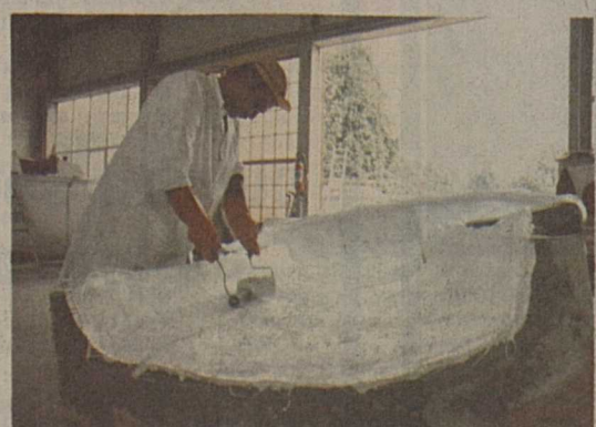
Passage au rouleau, pour bien imprégner la fibre de verre d'araldite. A relever que la structure finale comprend plusieurs couches de produits différents.
