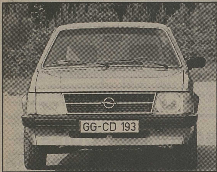
Le nouveau «nez» de la Kadett, sans agressivité, sans angles vifs, est néanmoins très élégant et sobre. La voiture a été étudiée en soufflerie et son CN a été amélioré.
