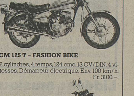
CM 125 T - FASHION BIKE 2 cylindres, 4 temps, 124 cmc, 13 CV/DIN, 4 vitesses. Démarreur électrique. Env. 100 km/h. Fr. 3100.-
