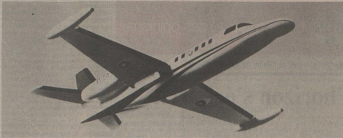
La société Israel Aircraft Industries vient de publier cette photo de maquette de la version de surveillance maritime du Westwind. Muni d'un radar frontal et de détecteurs installés sous la voilure, le modèle 1124N est capable de repérer des missiles évoluant au ras de l'eau. La Marine israélienne dispose actuellement de trois appareils de ce type.
