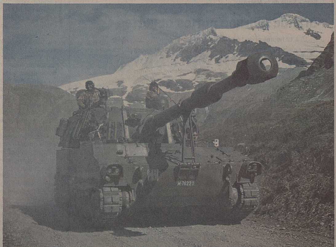
Dans le cadre du cours de répétition de la division mécanisée 4, un groupe d'obusiers blindés a été actionné dans la région du Simplon, au cours d'un exercice de prise de position, suivi de tirs réels, en présence des autorités locales et de nombreux invités. Voici un de ces obusiers blindés roulant sur une route alpestre. L'engin pèse 25 tonnes et le calibre de l'obusier est de 15,5 cm. Voir page 3 Photo NF
