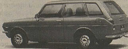
Toyota 1000 Copain break, 375 kg de charge utile, 3 portes, 993 cm 3 , 34,6 kW (47 ch DIN)
