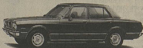
Toyota Cressida 2000 Sedan Deluxe, 5 vitesses, 1968 cm 3 , 65,5 kW (89 ch DIN), aussi en version automatique
