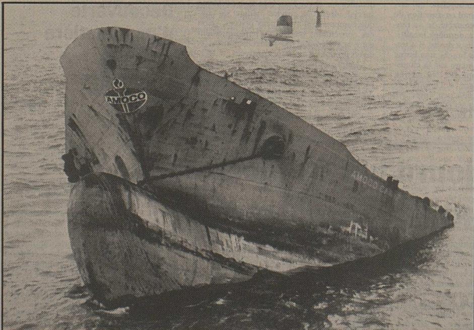
L'étrave brisée en deux par l'effet des vagues, mardi soir, a été bombardée hier afin d'ouvrir des brèches dans les réservoirs et de permettre au mazout restant de s'écouler. Seuls la proue et le haut du château arrière émergent encore.
