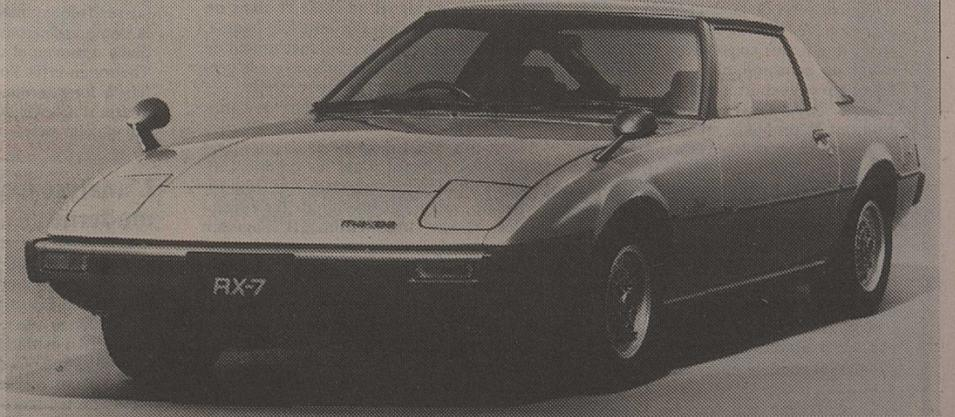
Heureux événement chez Mazda, où l'on vient de lever le voile sur la nouvelle RX-7, une jolie sportive 2 + 2. Comme l'indique traditionnellement la désignation « RX », il s'agit d'une voiture équipée d'un moteur rotatif. Sa cylindrée - en correspondance avec celle d'un
