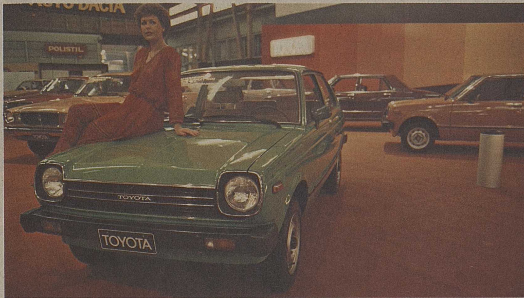
Ci-dessus: nouveau bas de gamme chez Toyota, avec cette petite Starlet disponible avec moteur 1000 ou 1300. Sous une caisse particulièrement compacte - elle mesure en longueur 10 bons cm de moins que la 2 CV - la Starlet cache un bouillant tempérament en offrant, selon le moteur, 58 ou 72 ch. Particularité rare également pour une voiture de cette catégorie: on peut obtenir en option une boîte cinq vitesses. Côté châssis, disons que celui-ci aurait peine à renier ses origines orientales, puisqu'on trouve une suspension McPherson à l'avant et un essieu rigide à l'arrière.
