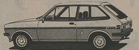
(1,3), synonyme de 66 CV bien tassés et d'une suspension raffermie avec un stabilisateur arrière. Pour des pointes à 158 km/h et une montée de 0 à 100 km/h en 12,3 secondes.
