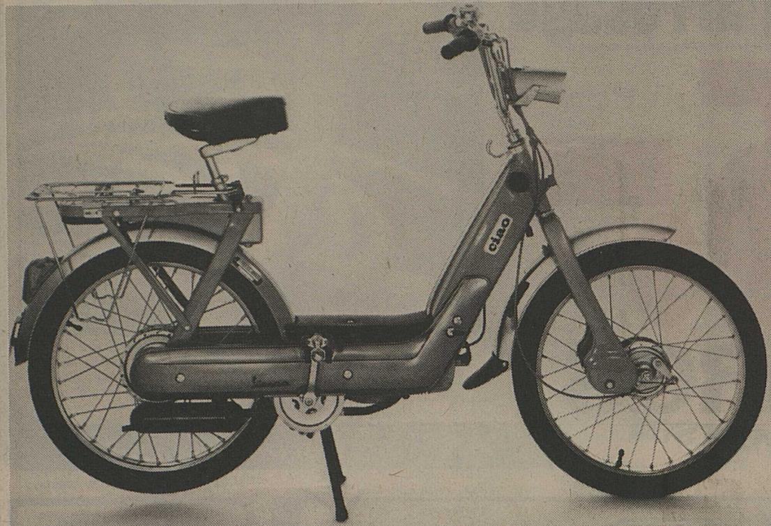
Le Ciao R Superconfort, avec double suspension: suspension à balancier à l'avant, et à l'arrière système à deux ressorts et lamelles dans l'appui de la selle.
