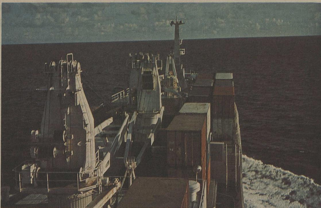
Les containers sont solidement arrimés sur le pont, au-dessus des cales frigorifiques
