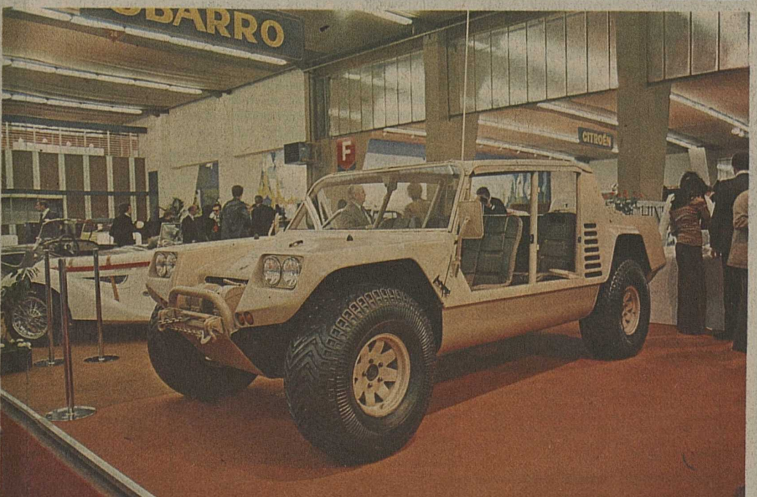
Lamborghini Cheetah Sacrifiant à son tour à la vogue des tous-terrains de luxe, Lamborghini présente cet étonnant véhicule, qui ne manque pas de se faire remarquer au milieu des coupés de hautes performances constituant le reste de la gamme. Le moteur - qu'on se rassure - n'est pas un V 12 de 4 litres - mais un gros V 8 Chrysler qui suffit à conférer la fougue nécessaire à cet engin.
