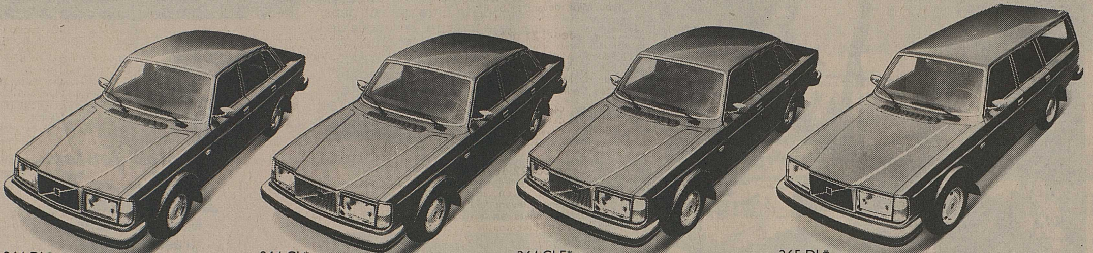
264 DL* 6 cylindres, 2,7 litres, 125 ch/DIN, carburateur
