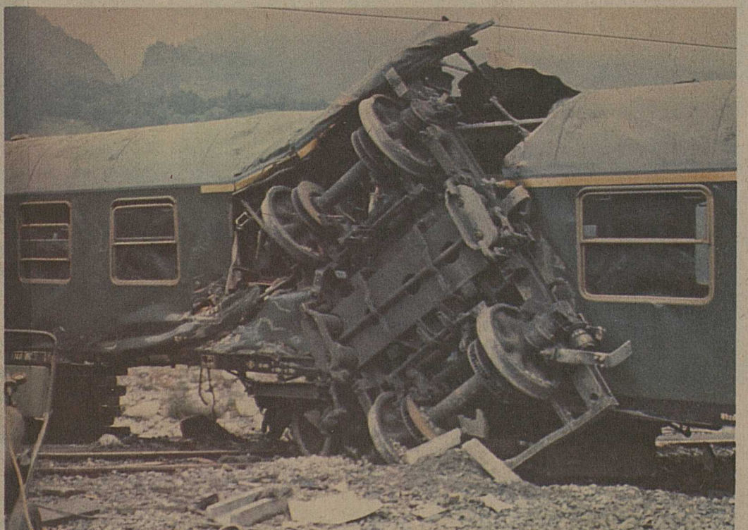
La puissante et toute nouvelle locomotive Re 6/6 de 10 600 ch. couchés sur le flanc. Avant de se renverser, elle a trainé sur plusieurs centaines de mètres, en pleine vitesse probablement, environ 500 tonnes, pulvérisant tout sur son passage. A droite: plaqué à angle droit sur le deuxième wagon, le double essieu du premier wagon. Photos NF
