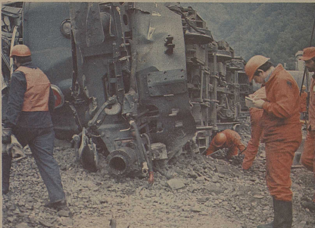
La puissante et toute nouvelle locomotive Re 6/6 de 10 600 ch. couchés sur le flanc. Avant de se renverser, elle a trainé sur plusieurs centaines de mètres, en pleine vitesse probablement, environ 500 tonnes, pulvérisant tout sur son passage. A droite: plaqué à angle droit sur le deuxième wagon, le double essieu du premier wagon. Photos NF
