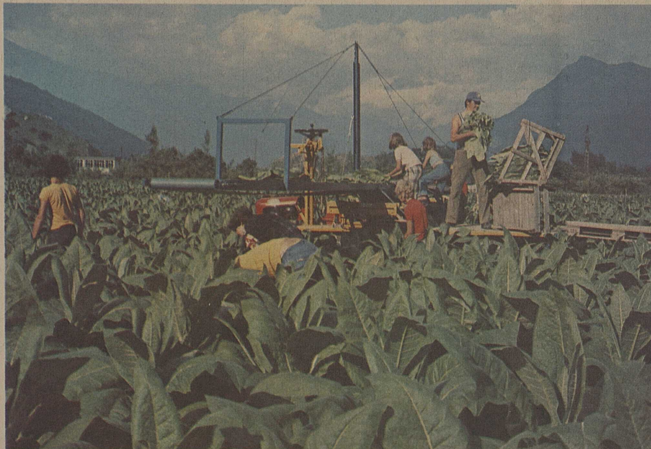
La sauterelle géante déplie ses tapis roulants au-dessus des feuilles de tabac et facilite ainsi le ramassage des récoltes, choux, oignons, pommes de terre, etc.
