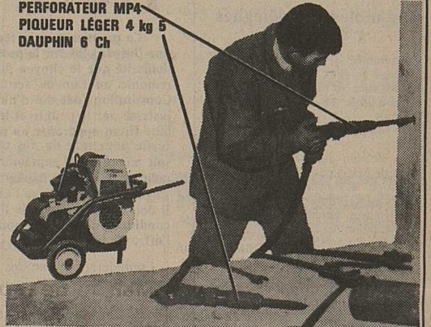
Robustes, maniables, ces compresseurs peuvent être utilisés chaque jour sur les chantiers, avec perforateurs, marteaux-piqueurs, vibrateurs, règles, sableuses, machines à crépir, etc.
