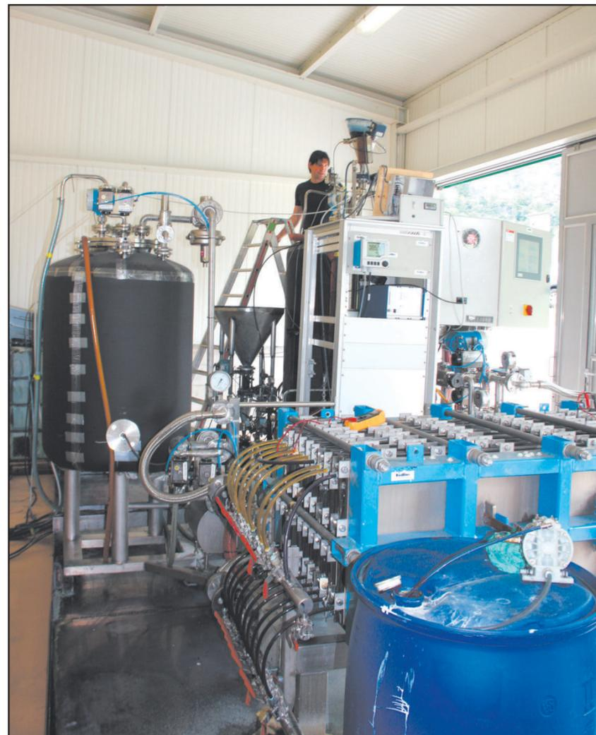
Le prototype de la machine à produire de l'indigo au moment des derniers réglages avant la phase industrielle et commerciale pour laquelle elle recevra un habillage plus élégant. LE NOUVELLISTE
